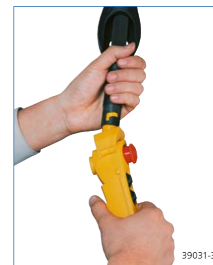
Stecker mit Bajonettverschluss in den Steuerschalter stecken und in Verriegelungsposition drehen
