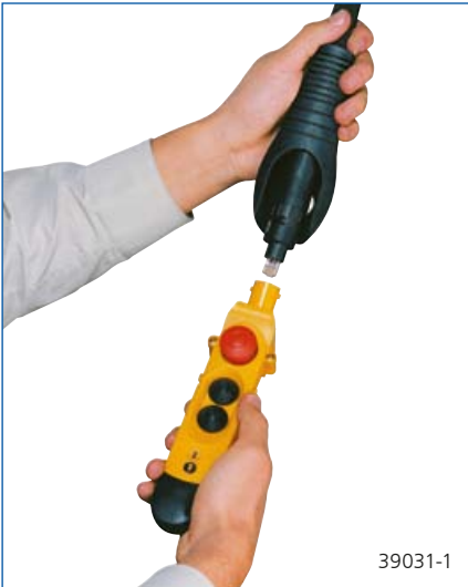
Knickschutz über Steuerleitung nach oben schieben
