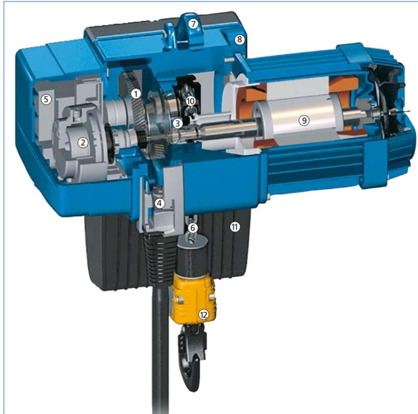
① **Getriebe** – bis 10 Jahre wartungsfrei. Mit der FEM-Triebwerksgruppen-Einstufung Demag 2m+ setzt der DC-Pro einen neuen Marktstandard mit 1.900 Volllaststunden-Nutzungsdauer. Das bedeutet im praktischen Einsatz eine um rund 20 % längere Lebensdauer. Die Schrägverzahnung aller Getriebestufen sorgt für Geräuschminimierung und hohe Laufruhe.
