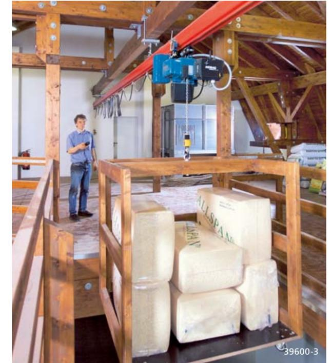
wodurch ein dauerhaft sicherer Zustand für den Bediener gewährleistet ist. Die kompakte und leichte 24 V-Schützsteuerung sorgt somit dafür, dass das System nur minimalem Verschleiß unterliegt. Der Nachlaufweg ist zugleich sanft und ruhig.
