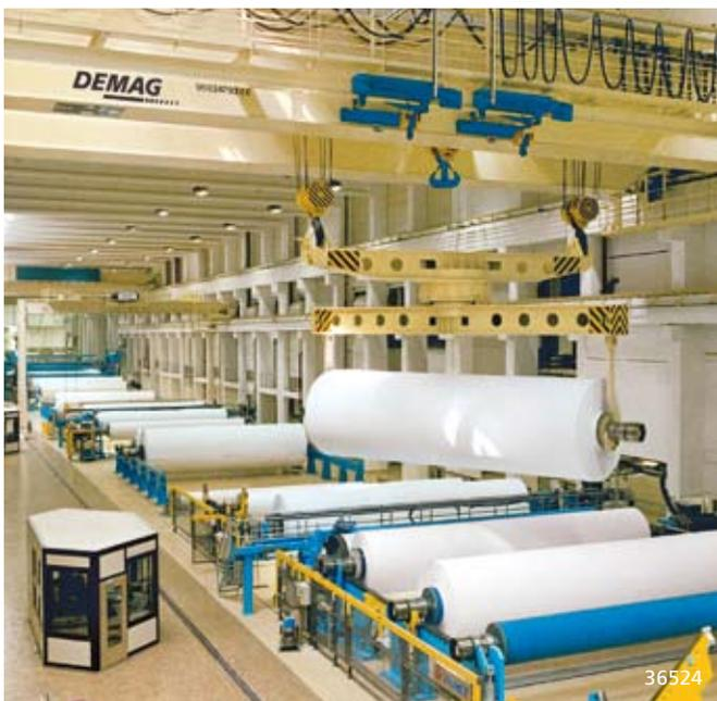
Papierveredelung: Demag-Zweitträger- kran mit motorisch drehbarer Traverse transportiert den Tambour aus dem Zwischenlager zur Weiterverarbeitung.
