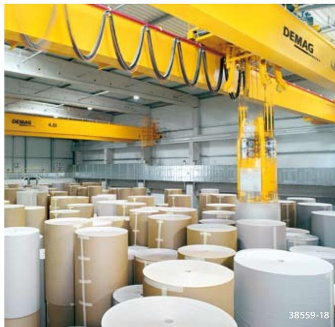
Rollenlagerung: Pendelfreies Handling der Papierrollen durch mechanische Fixierung des Vakuumhebers in höchster Position.
