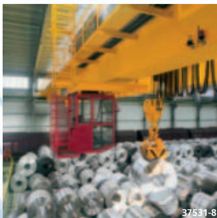
Komfort-Kabineabmessungen: Höhe = 2.200 mm; Breite = 1.600 mm; Tiefe = 1.600 mm. Großflächige Verglasung, vielfach aufklappbar. Verstellbarer ergonomischer Steuersessel. Beidseitige Anordnung der Bedienelemente am drehbaren Steuersessel. Sonderausstattungen für Innen- und Außenbetrieb, Heizung und Klimatisierung je nach Einsatzumgebung.
