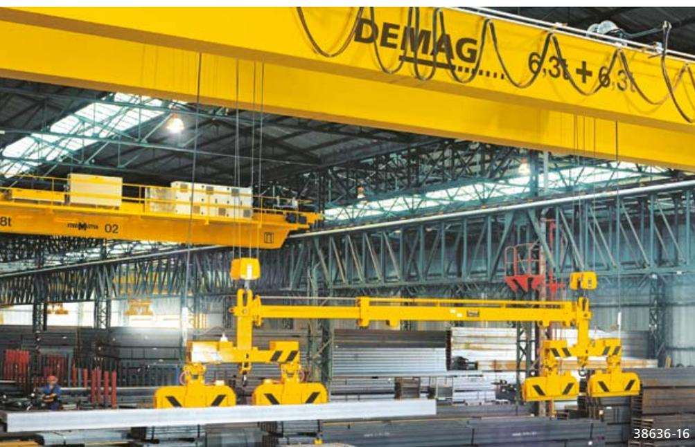
Demag-Steelmaster mit Magnettraverse zur Aufnahme von Langgut, Einzelstücken bzw. Blechen
