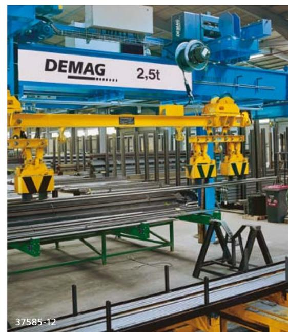
Demag-Coilmaster im vollautomatischem Coillager mit Magneten oder Greifern als Lastaufnahmemittel
