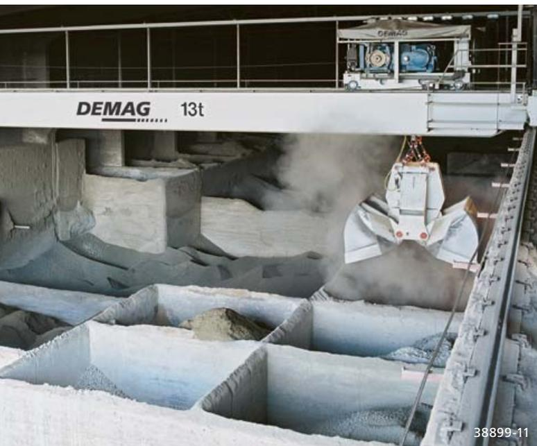
Vollautomatisches Befüllen und Entnehmen der unterschiedlichen Zuschlagstoffe mit einem Demag-Automatikkran in einem Zementwerk
