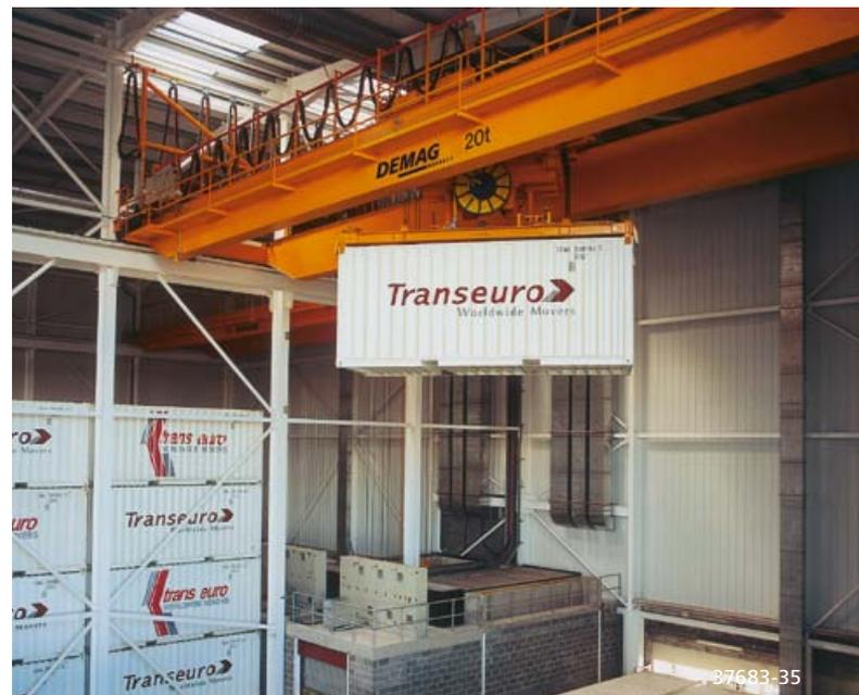
Automatischer Spreader für 20- und 40-Fuß-Container.
