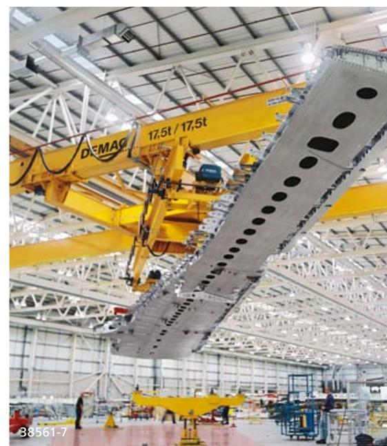
Demag-Prozesskrane bieten individuelle Lösungen beim Transport von ganzen Flugzeugrümpfen, Flügeln oder Rumpfsegmenten in der Flugzeugproduktion
