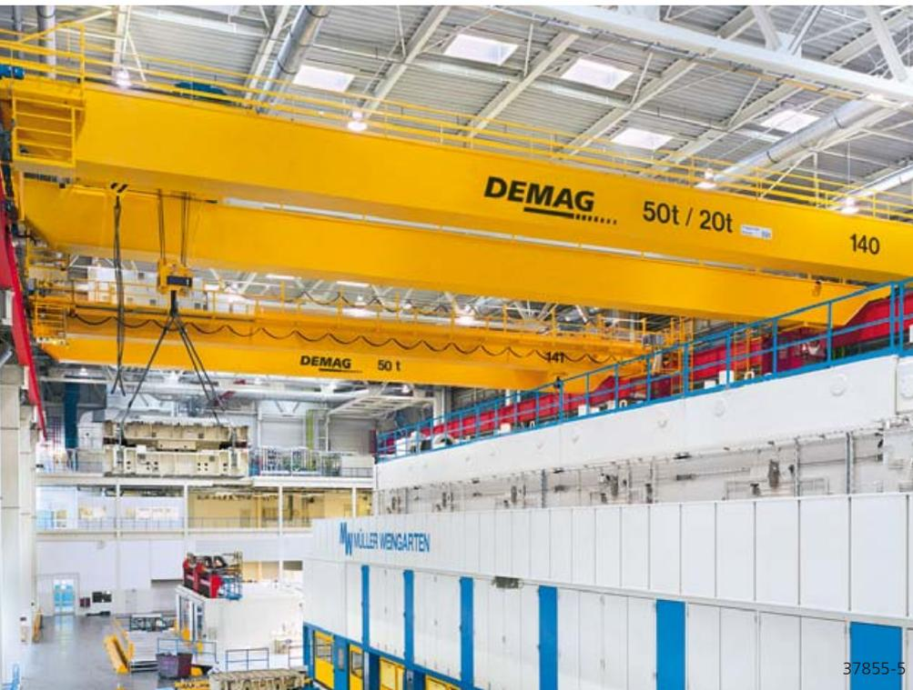
Demag-Prozesskrane im Presswerk für Werkzeugwechsel in der Automobilindustrie
