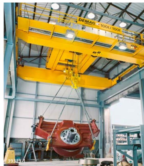
In der Produktion von Brecherteilen werden Wendekrane eingesetzt
